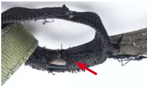
Bild 13: Verschleiß unten am Beinschlaufensteg
