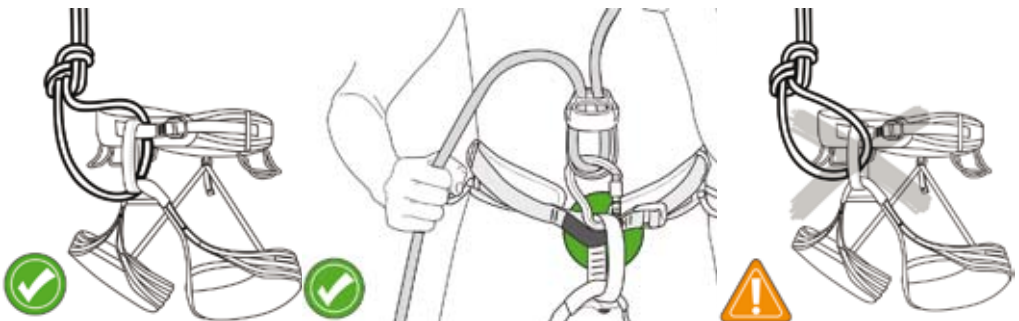
Bild 8: Black Diamond: Anseilschlaufen zum Einbinden, Sicherungsring zum Sichern – Warnung vor Einbinden [5]
