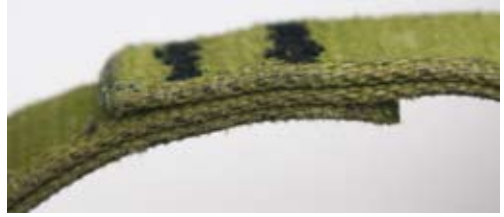
Bild 11: zweilagiger Sicherungsring: Petzl, gebraucht
